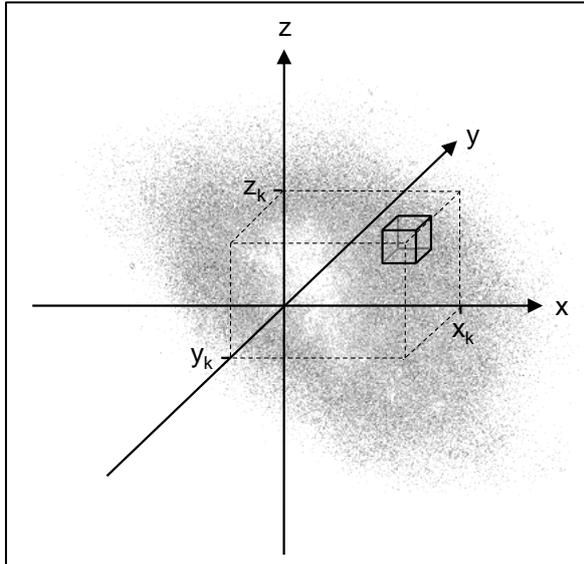
Abbildung 1: Volumenelement mit den Koordinaten  $x_k$ ,  $y_k$  und  $z_k$  in einem materieerfüllten Raumbereich.
